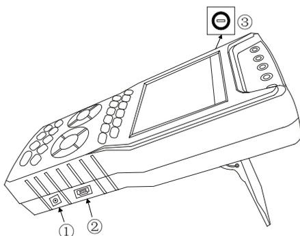
①、电池充电插口：用于电池充电器/通电电源的插口
