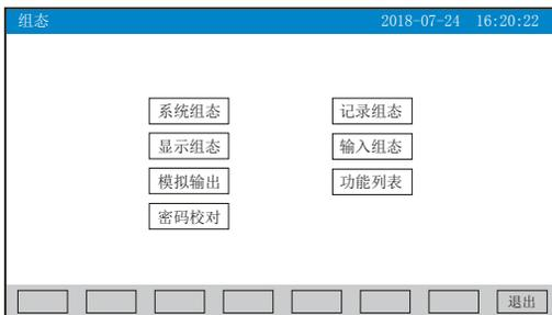
进入组态首先要进行密码校对，点击“密码校对”将出现一对话框，在对话框输入密码（对话框操作可参见第21页“六、T6输入法”一节）。密码由6位数据组成，出厂默认密码为000000，用户可以在“系统组态”——“用户密码”一栏修改校对密码。若密码输入错误，用户将不能进入各组态画面。
