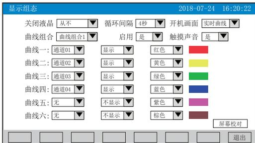
★关闭液晶：降低液晶屏的背光亮度，可选择5分钟后、10分钟后、30分钟后、1小时后、从不关闭
